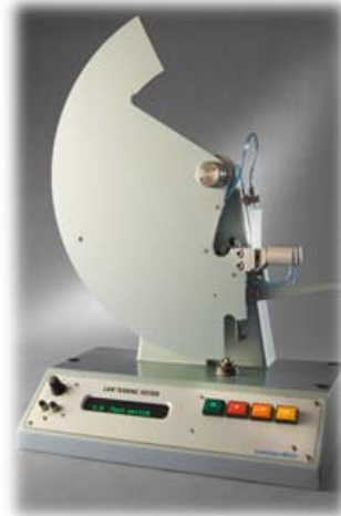
Fig. 28. 인쇄용지의 인장강도와 인열강도를 측정한 인장강도시험기(좌)와 인열강도시험기(우).
